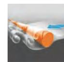
Mähfäden sind in unterschiedlicher Geometrie und Stärke für verschiedene Anwendungsbereiche erhältlich. Dank einer spiralförmig eingepprägten Nut sind einige unserer Mähfäden geräuschärmer als herkömmliche runde Mähfäden. Die Vertiefung in der Fadenoberfläche unterbricht den gleichmäßigen Luftstrom. Wirbel entstehen, das Pfeifen wird reduziert, das Mähgeräusch wird deutlich leiser.
