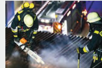
Spezial-Sägekette für härteste Einsätze von Feuerwehren, Rettungsdiensten und Technischem Hilfswerk (z.B. Holz mit Nägeln, Verbundmaterial und Panzerglas). Schneidezähne mit vollflächiger Aufpanzerung aus schlagzähem Hartmetallplatten.
