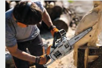
Spezial-Sägekette für Holzschnitzer. Vibrationsarm, sehr gute Schnittleistung, durch gekürztes Zahndach kein Drücken beim Stechvorgang nötig, erreicht höhere Stechgeschwindigkeit als herkömmliche 1/4"-Sägeketten.
