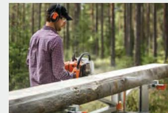
Spezielle Längsschnitt-Sägekette für den Einsatz auf Längsschnitt-Geräten sowie mobilen Kleinsägewerken. Halbmeißelzahnkette mit hoher Schnittqualität bei niedrigem Vibrationsniveau und weichem Schneidverhalten. Für mehr Informationen besuchen Sie Ihren Fachhändler.
